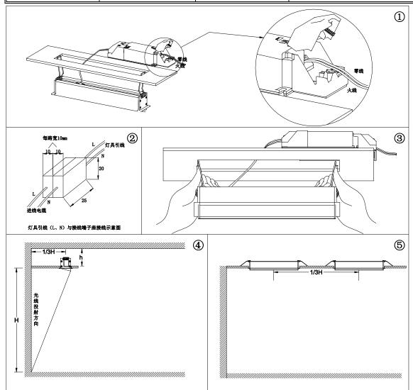
\* 若灯具的电器自带引线,且此连接引线需要与一个独立的接线端子座进行连接(参考图2示意图接线),每路接线端 子座尺寸应不小于10x20x25mm。
