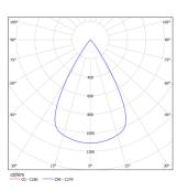
型号:TL51FLM11-X-F930光束角:最宽60°时系统功率:13 W系统光通量:838 lm中心光强:930 cd系统光效:64 lm/W
