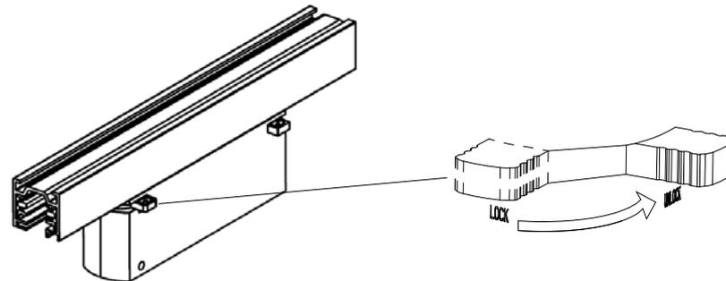
3. 最后将导轨灯连接器一端往下拉即可取下整个导轨灯连接器。
