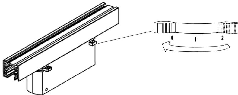
2. 然后将锁紧手柄逆时针旋转由“LOCK”状态切换到“UNLOCK”状态。
