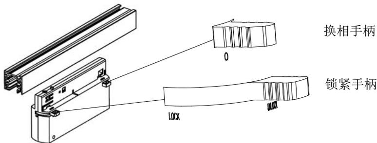
2. 装配前将导轨灯连接器的凸台对准导轨的凹槽。
