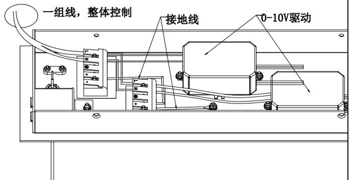
④将电源线与接线端子按极性标识连接好。接好线后将吸顶盘与吸顶盒用不锈钢螺丝 ③ 锁在一起。
