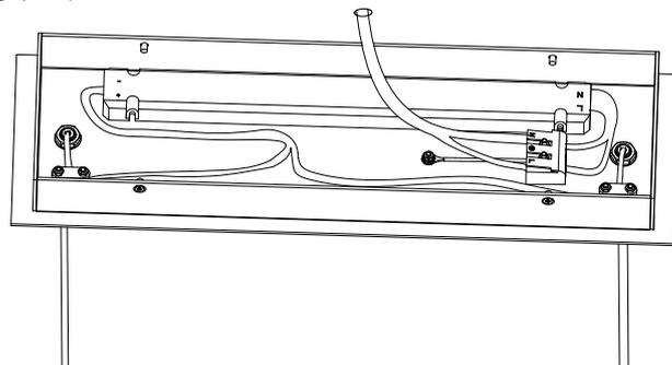
⑤将电源线与接线端子按极性标识连接好。接好线后将吸顶盘与吸顶盒用不锈钢螺丝 ③ 锁在一起。
