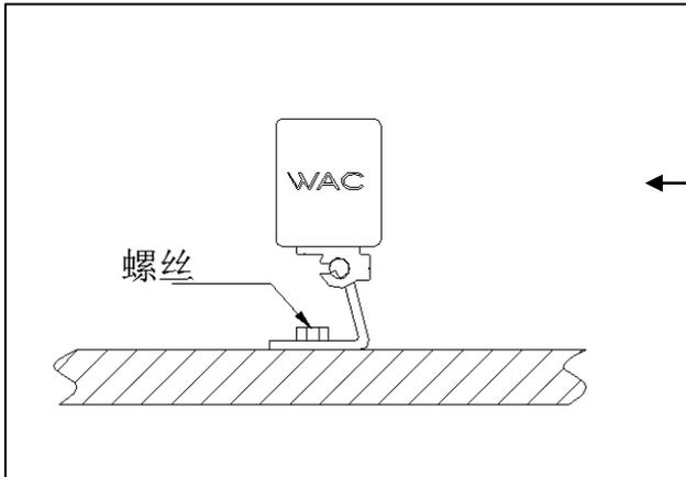
将灯具放置在安装面上，并用 ST3.9 自攻螺丝锁紧
