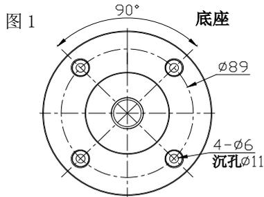
根据底座安装孔尺寸, 打底孔
