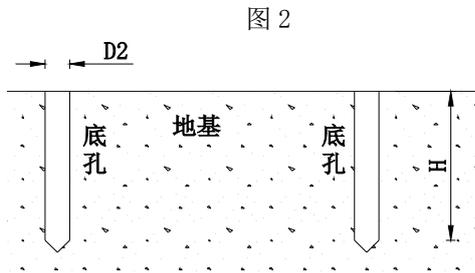
底孔直径  $D2 = \text{膨胀套外径 } d$
