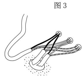
电源线与市电相连, 连接端须做好防水、防漏电措施
