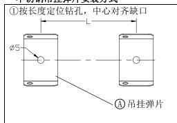
②装好膨胀螺丝后,用自攻螺丝锁好吊挂弹片
