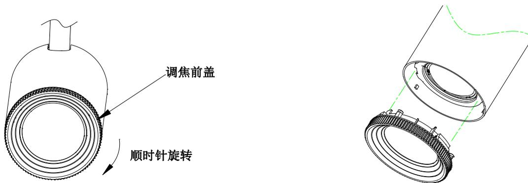
2. 将玻璃或其它配件换入后，将调焦前盖两处的耳朵对准灯体内调焦组件的缺口装入（注：灯体上的 3 处凸点需跟调焦前盖上的 3 处缺口配合装入），逆时针旋转到需求的光斑大小，即可完成配件安装。
