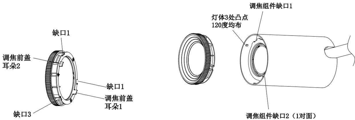
3. 如下图片示意，先将卡簧取出，将其它同尺寸的玻璃或配件放入调节前框组件内，将卡簧的三处折弯凸处卡入调节前盖侧边的三处缺口处，即可完成拆换玻璃步骤。
