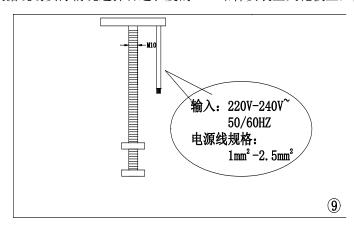
2、把灯体安装进吊杆里,用螺母固定锁紧灯具;用防水接线盒将灯具线与天花板上的电源输入线连接好,如下图所示(图示防水接线盒不附送)。
