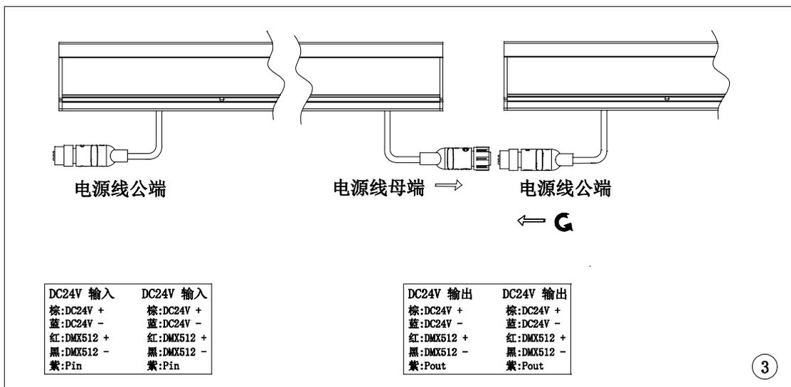
备注:1. 建议每一电源回路所接灯具拼接总长不超过 8 米，每一个 DMX 信号放大器所接灯具不超过 26 盏为宜，如有干扰，请根据现场安装情况增加放大器。
