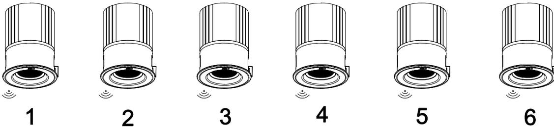
安装灯具前, 请先检查灯具的编号, 按照灯具编号顺序排列安装, 同时请详细记录灯具编号位置分布。并且以灯具指示灯为基础, 统一灯具朝向安装
