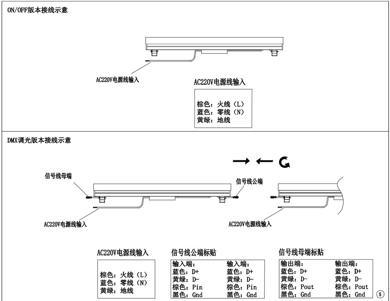
6. 恒压220V/AC DMX512调光灯具接线方式
