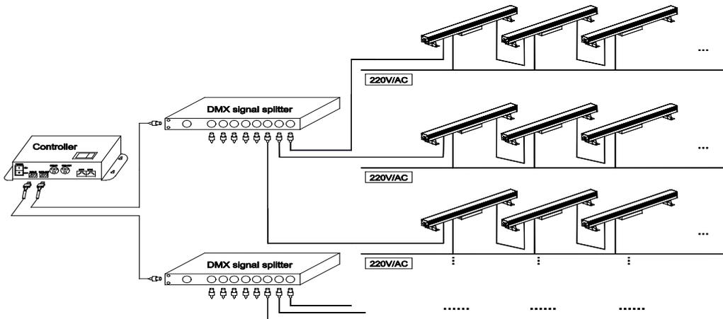
**备注：**导线连接须使用 IP66 及以上等级防水接线盒，接线盒的防水接头须和灯具引线相匹配，每一个 DMX 信号放大器所载灯具，建议 ELS510-\*系列不超过 16 盏， ELS505-\*系列不超过 32 盏为宜。
